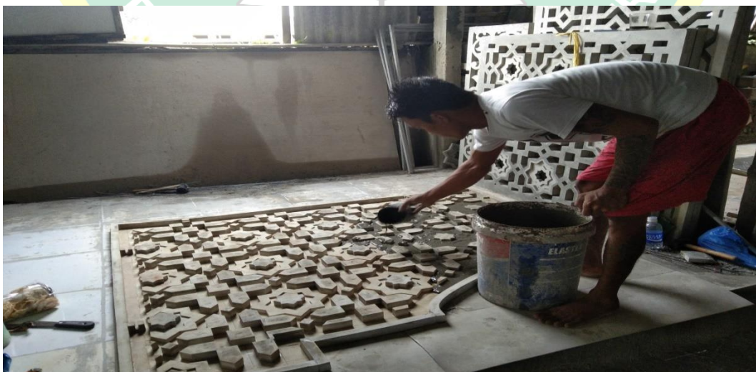
Gambar 4.11 Proses Produksi Menggunakan Teknik Cetak Tuang
