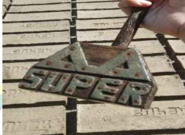
Gambar 4.6 Pemberian Cap pada Batu Bata
